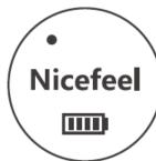
На дисплее горит одна синяя лампа: включен **режим 1** (давление струи 69-275 кПа).
